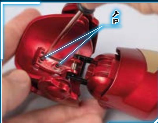
2 - Закрепите наплечник двумя винтами IP. Проверьте, свободно ли он двигается и легко ли возвращается в исходное положение.
