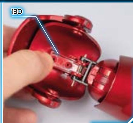
1 - Теперь мы присоединим собранный наплечник к руке. Соедините наплечник с его опорой (13D) так, как показано на фотографии. Опора наплечника — это вращающаяся на оси подпружиненная деталь, которая закреплена на рамке плечевого сустава (11B).
