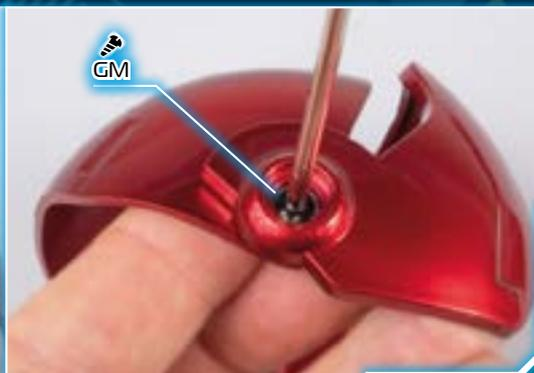
3 - Зафиксируйте шарниры снаружи двумя винтами GM. Убедитесь, что они позволяют пластинам легко вращаться и не раскручиваются. Закройте шляпки обоих винтов двумя заглушками (14D).
